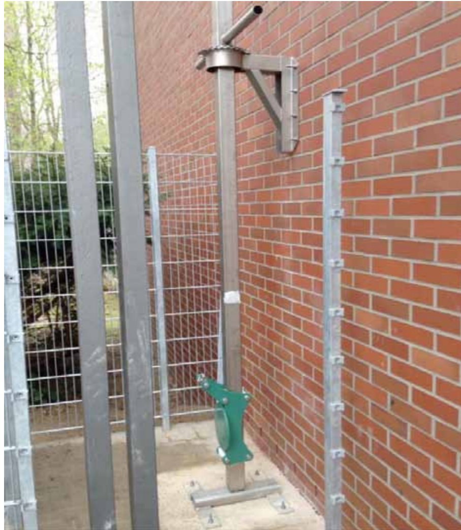
Abb. 4: Testaufbau Rührwerksmast mit Schlitten für Sensorkopf
