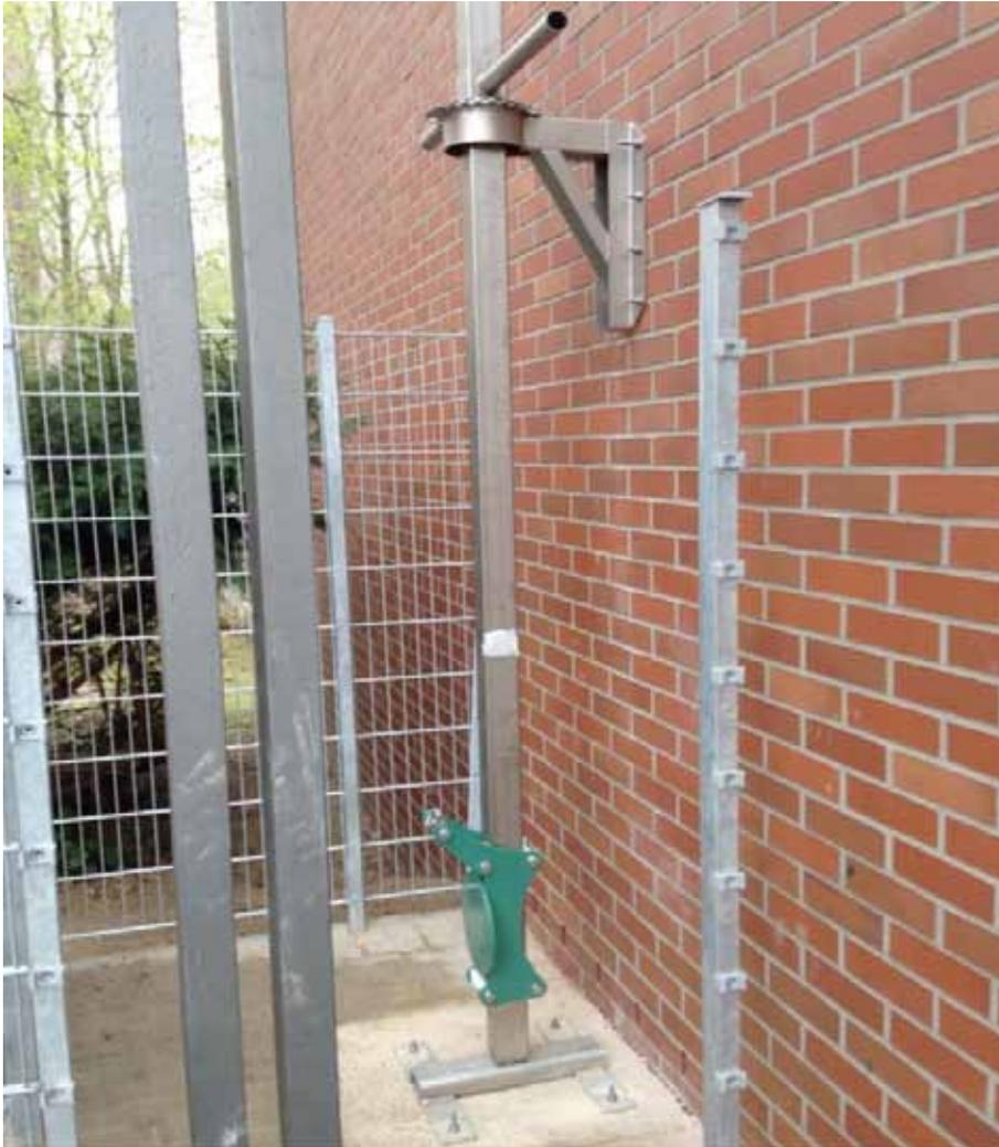
Abb. 4: Testaufbau Rührwerksmast mit Schlitten für Sensorkopf
