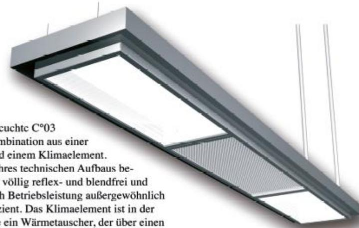
Die Klimaleuchte C°03 ist eine Kombination aus einer Leuchte und einem Klimatelement. Aufgrund ihres technischen Aufbaus beleuchtet sie völlig reflex- und blendfrei und mit 110 W/h Betriebsleistung außergewöhnlich energieeffizient. Das Klimatelement ist in der Hauptsache ein Wärmetauscher, der über einen Kaltwasseranschluss betrieben wird. Basierend auf dem Prinzip der Schwerkraft ergibt sich eine Kühlleistung von bis zu 400 - 800 Watt. Sie kann optional durch Ventilatoren unterstützt werden.
