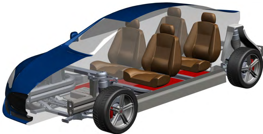
Abb. 4 Originalversion des Tesla S; Batterie in rot dargestellt
