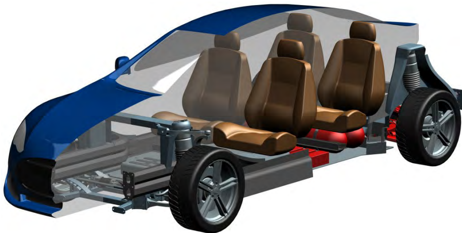
Abb. 5 Fahrzeug in der Neukonzeptionierung; Austauschchteile in rot dargestellt
