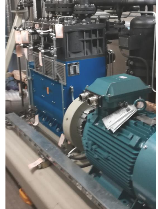
Prototyp der TMS-Kombimaschine im Zittauer Kraftwerkslabor
